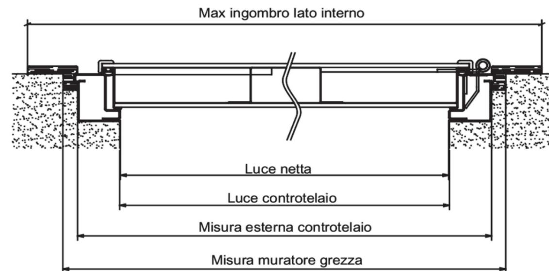
Particolare falso telaio più telaio
