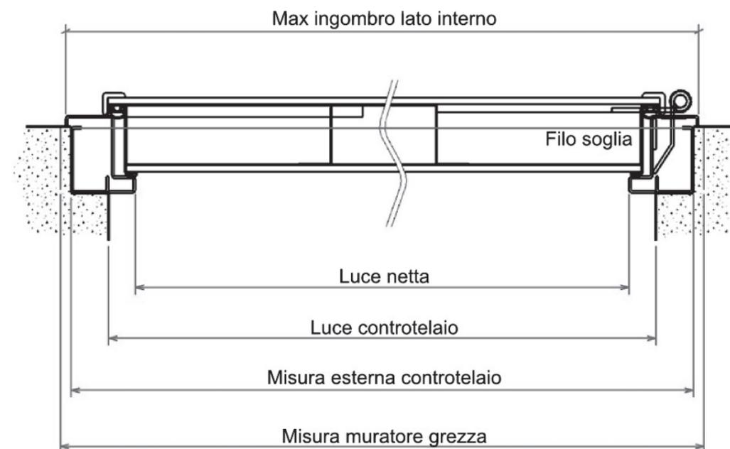
Particolare falso telaio più telaio
