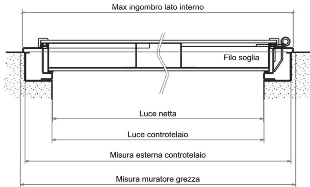
Particolare falso telaio più telaio
