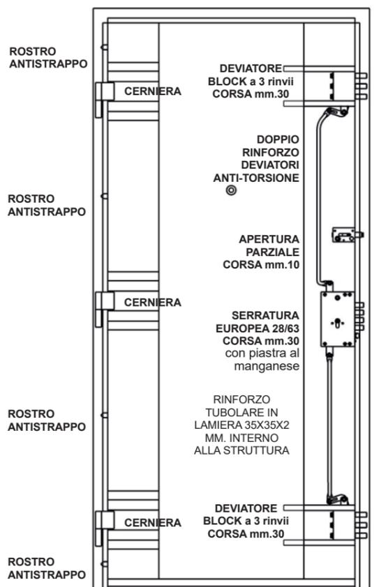
CONTROTELAIO In acciaio zincato spessore mm.2
