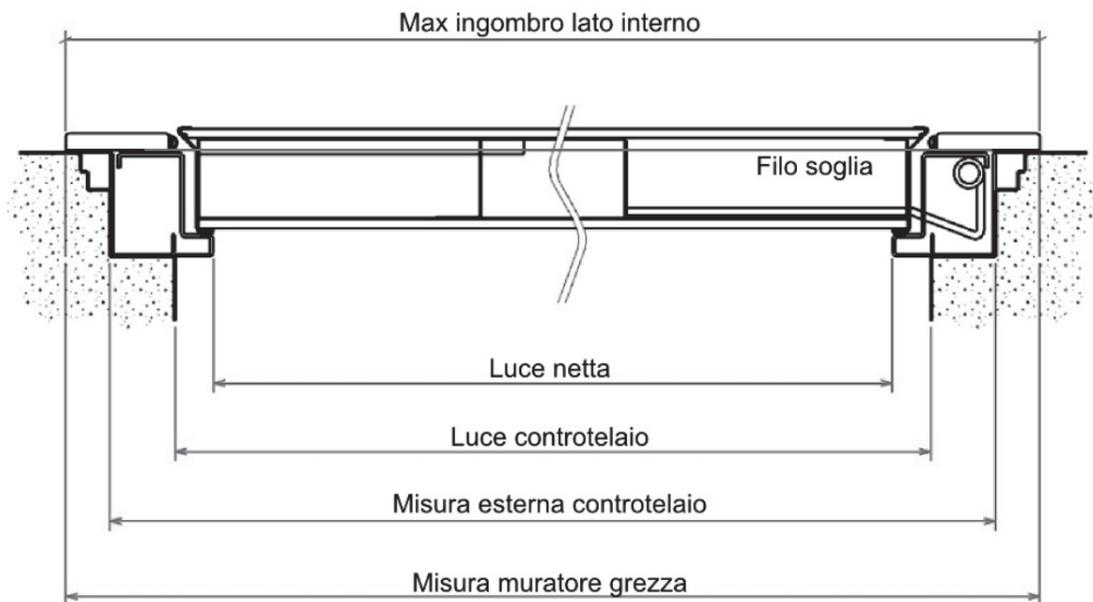
Particolare falso telaio più telaio
