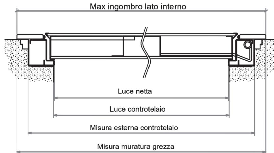
Particolare falso telaio più telaio
